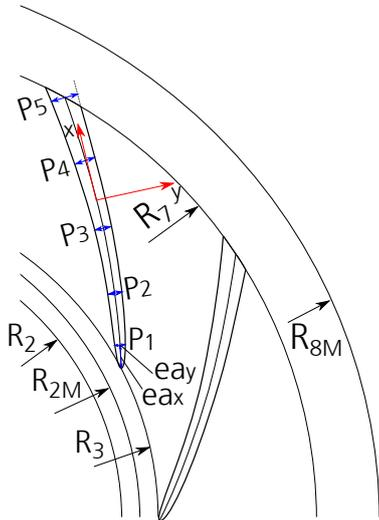
Figure 1: Diffuser parametrization
